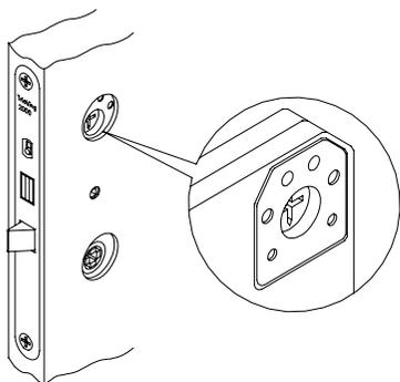
3. Etter at sylinderen er festet med sine skruer (4 stk.), skrus sylinderringene inntil dørbladet og festes med settskrue. Forsikre om at sylinderen fungerer. Sylinder-skruene dekkes med skivene som presses inn i hullene over skruene.
