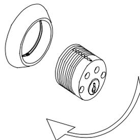
2. Monter utvendig og innvendig sylinder/knappsyylinder på plass. Gjennomboret sylinder på innsiden. Merk at låsens sylinderfallrør (hvor sylinder går inn i låskassen) stilles som vist på etiketten på låsen.
